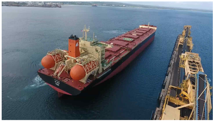
<사진설명> 정부 지원으로 건조한 에이치라인의 LNG추진 벌크선HL ECO호
